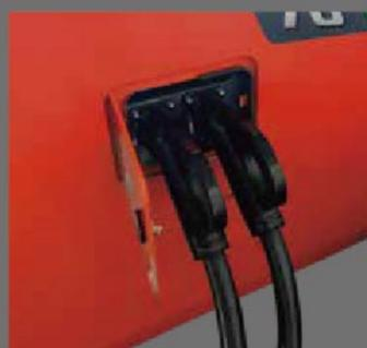
Le chariot élévateur à batterie lithium est équipé d'un système de charge à double pistolets standard, ce qui réduit considérablement le temps de charge. Les batteries lithium ont une capacité de haute densité et peuvent être utilisées et chargées à tout moment pour permettre un fonctionnement efficace et continu tout au long de la journée.
