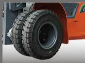
Les roues avant sont équipées de pneus doubles standards, avec une meilleure capacité de charge.
