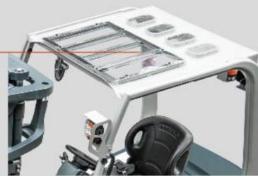
Le protège-conducteur intégral estampé avec une couverture transparente imperméable qui garantit le fonctionnement par temps de pluie.
