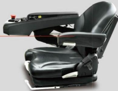
Le siège à suspension intégrale Grammer est en option pour une conduite plus confortable. L'accoudoir multifonctionnel intègre l'interrupteur à pouce, l'interrupteur de direction, l'interrupteur de virage, l'engrenage PES, le bouton de klaxon, l'interrupteur d'arrêt d'urgence, etc., pour une utilisation facile et un contrôle précis du rapport électromagnétique.
