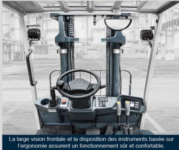
La large vision frontale et la disposition des instruments basée sur l'ergonomie assurent un fonctionnement sûr et confortable.
