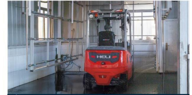
Étanchéité IPX4 : le véhicule est mis sous tension pour simuler un essai de 15 minutes de courte durée sous une pluie de 5000L, et le véhicule peut continuer à fonctionner sans défaillance.
