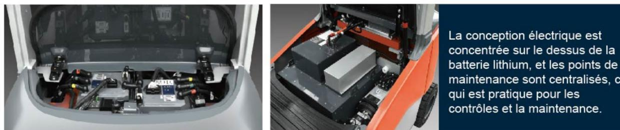
La conception électrique est concentrée sur le dessus de la batterie lithium, et les points de maintenance sont centralisés, ce qui est pratique pour les contrôles et la maintenance.
