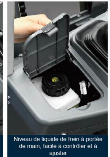
Niveau de liquide de frein à portée de main, facile à contrôler et à ajuster
